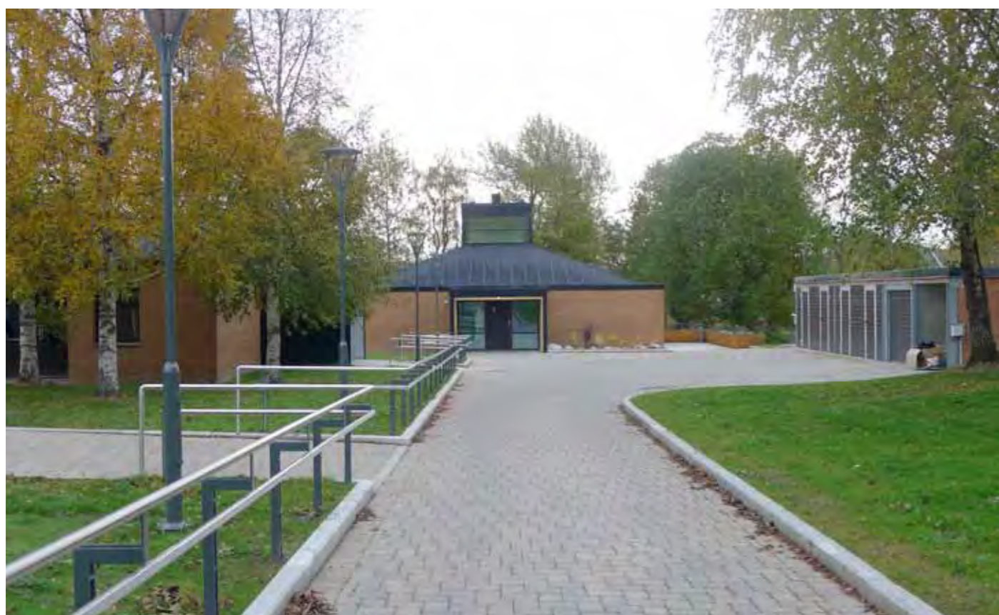
En liten kant varsler at du kommer til og krysser veien til en inngang. Kan være et problem om vinteren med snø
